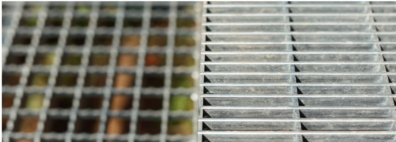
Прессованные решетчатые настилы изготавливают из продольных и поперечных полос методом холодного прессования под высоким давлением. В результате происходит вдавливание связующей полосы в специально подготовленные пазы несущей. Такое соединение обладает исключительной прочностью и надёжностью.
