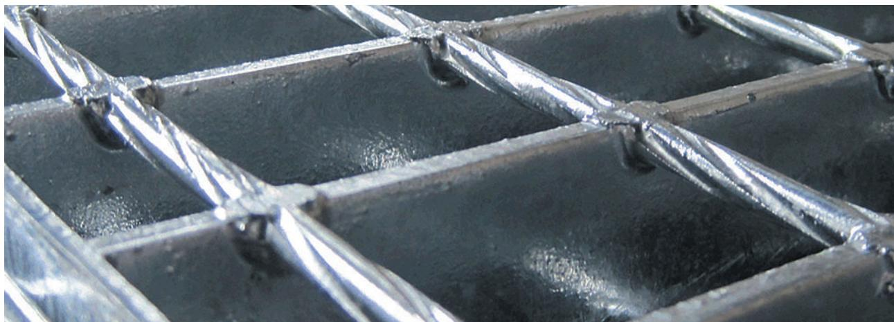
Сварные решетчатые настилы изготавливаются на основе технологии электроплавки, которая осуществляет полное взаимопроникновение двух компонентов решетчатого настила: несущих полос и связующих прутков.
